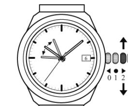
Par activation des fuseaux horaires sur 1 tour de cadran, le mois est corrigé à chaque passage de l'aiguillage des heures par 12 heures. Cela dans le sens de rotation de la couronne (sens horaire: incrémentation de la date, sens anti-horaire: décrémentation de la date).
