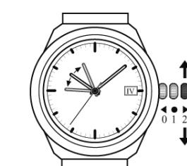
Par activation des fuseaux horaires sur 1 tour de cadran, le cycle annuel est corrigé à chaque passage de l'aiguillage des heures par 12 heures. Cela dans les 2 sens de rotation de la couronne (sens horaire: incrémentation de la date, sens anti-horaire: décrémentation de la date).
