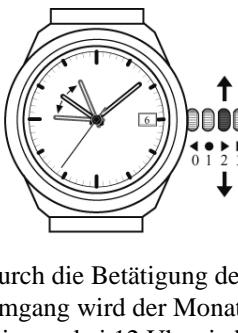
Durch die Betätigung der Zeitzonen über 1 Zifferblatt-Umgang wird der Monat beim Durchgang des Stundenzeigers «bei 12 Uhr» jedes Mal korrigiert. Dies in beide Drehrichtungen der Krone (im Uhrzeigersinn: Vorwärts schalten des Monats, entgegen dem Uhrzeigersinn: Rückwärts schalten des Monats).
